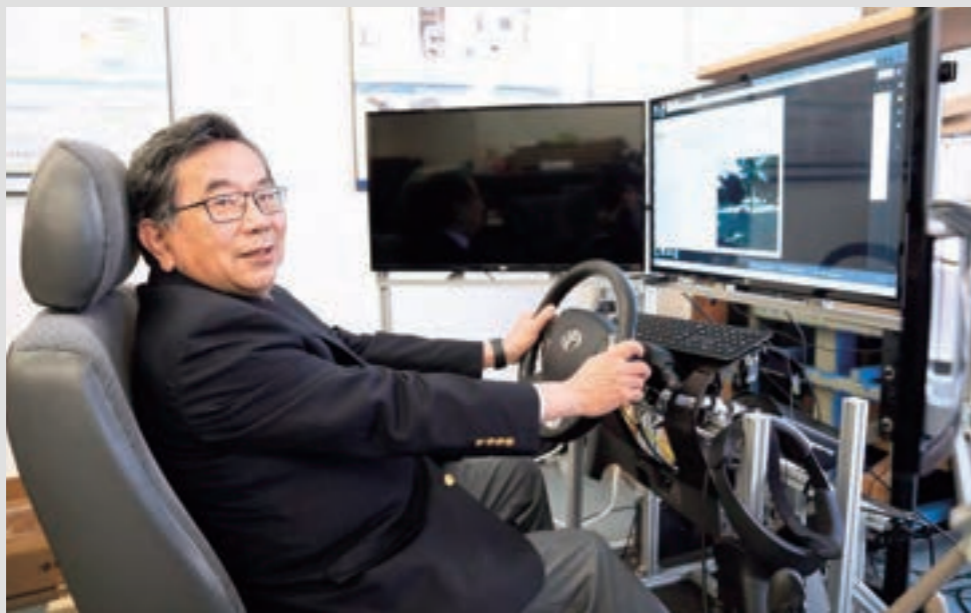
ドライバーのハンドル/アクセル/ブレーキ操作の解析と 自動走行のシミュレーション実験を行うシミュレータ
