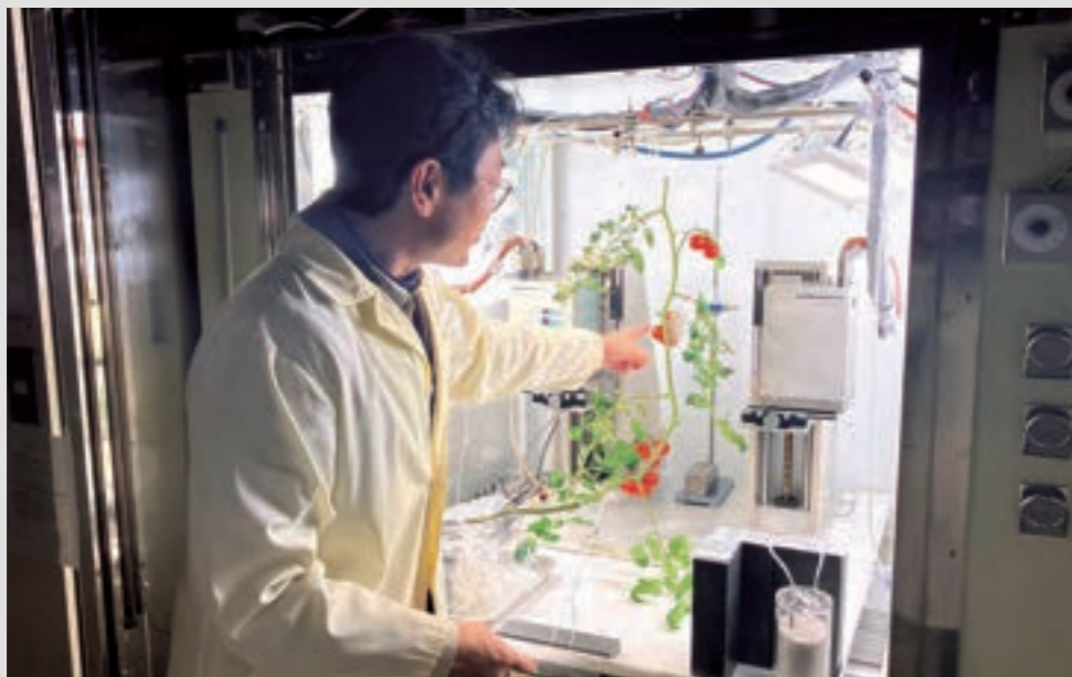
トマトの栄養の流れをRIイメージングで可視化するための実験装置 撮影協力:QST高崎量子技術基盤研究所
